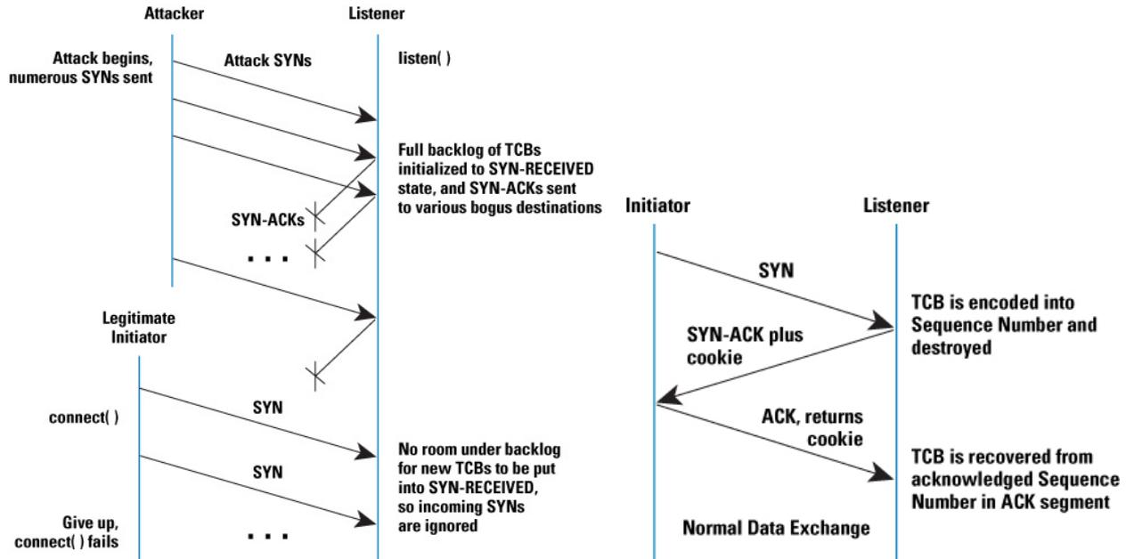
**Защита** – частичная за счёт уменьшения таймаутов между SYNs-ACK-с и ACK-s; полная защита за счёт введения cookie (квитанции), см. рис. ниже или за счёт четырёхкратного рукопожатия с cookie, см. протокол SCTP.
