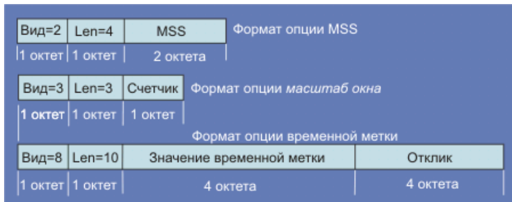
Рис. Формат опций для TCP-сегментов.
