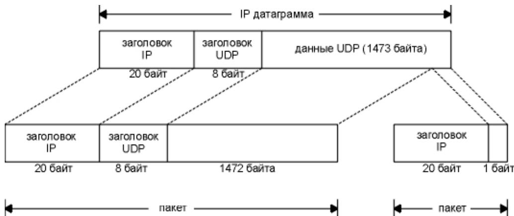
Рис. Пример IP фрагментации для UDP дейтаграмм.
